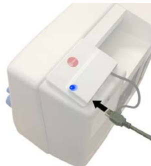
Rysunek 10.1.6. Podłączanie urządzenia PhysioFlow Q-link.
