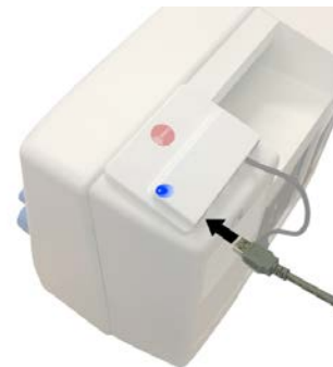
Abbildung 10.1.6 Verbinden der PhysioFlow Q-link.
