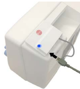
Abbildung 10.1.6 Verbinden der PhysioFlow Q-link.
